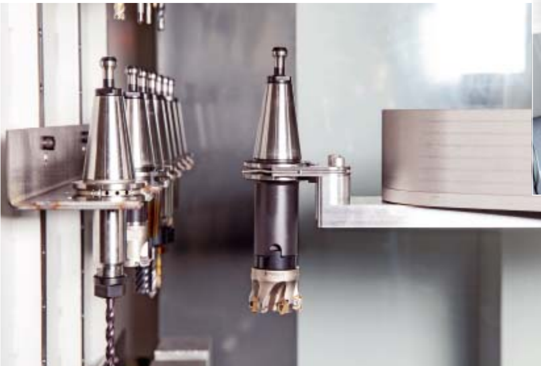
Der 4-Achsen-Roboter der Automationszelle wechselt Werkzeuge und Werkstücke direkt vom Regalmagazin ins 5-Achsen-Zentrum UMC-750.
