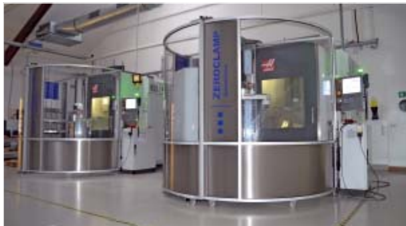
Die Automationszelle ist vor dem Bearbeitungszentrum platziert. Links sind die bis zu drei Regalmagazine angeordnet, von rechts hat der Bediener freien Zugang.
