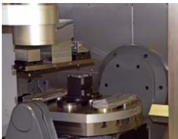
Im Standard kommt in der Zelle das 0-Punkt-Spannsystem Zero Clamp zum Einsatz. Der Anwender kann aber auch bereits vorhandene Systeme anderer Anbieter verwenden.
