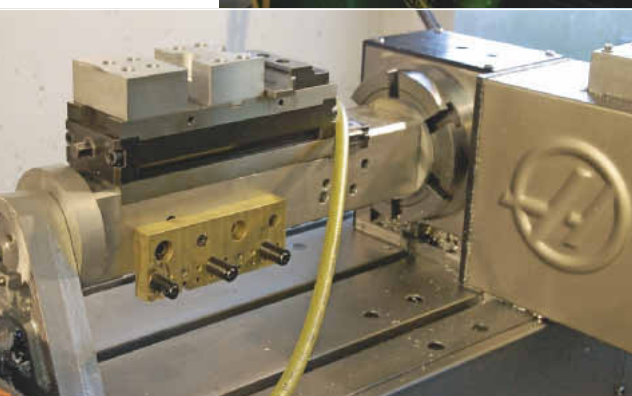
Dank der Spannbrücke – einem Zusatzequipment von Haas – fertigt Vosseler jetzt flexibler, und Rüstvorgänge wurden erheblich beschleunigt
