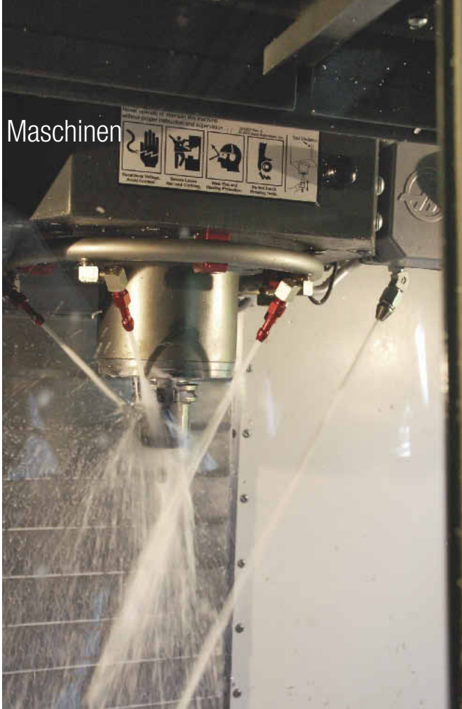
Der Kühlmittelring mit verstellbaren und programmierbaren Düsen ist ein Beispiel für praxisnahes Design
