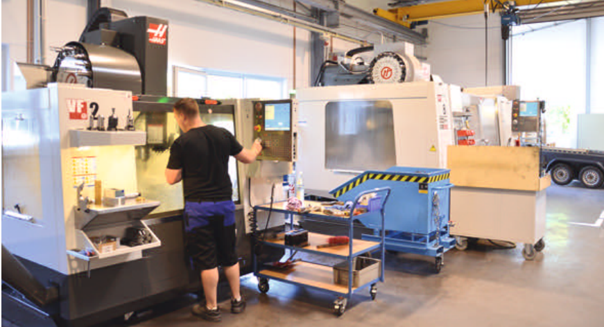
Aluminium-Zerspanzentrum: In der Produktionshalle stehen die beiden Vertikal-Maschinen VF-2 und VF-8 nebeneinander.
