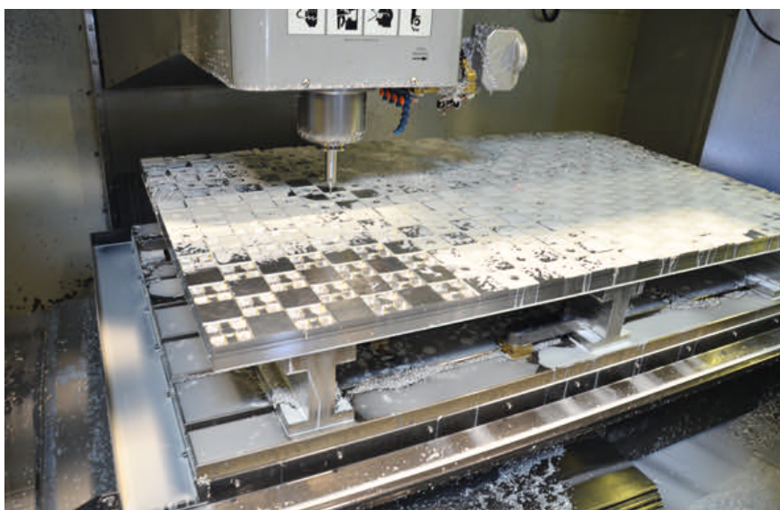
Für warme Füße: In der Aufspannung des Fräszentrums VF-8 ist das Kernwerkzeug für eine Fußbodenheizungsplatte. In die Vertiefungen werden später Heizschleifen verlegt. Gefräst wird mit einem 6 mm-Radiusfräser mit 8000 U/min. Der Vorschub beträgt 3500 mm/min.
