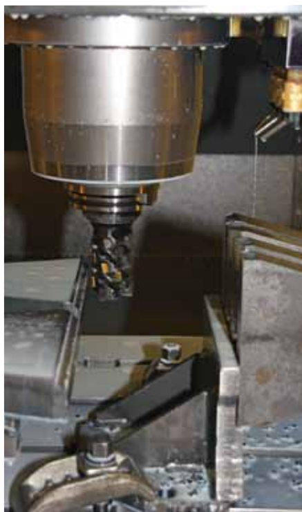
In der SK-50-Spindel wird hauptsächlich mit Wendeschneidplatten-Werkzeugen gearbeitet.
