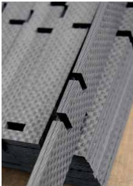
Aus dem Composite-Werkstoff CFC entstehen unter anderem Vorrichtungen, die in der Wärmebehandlung eingesetzt werden.
