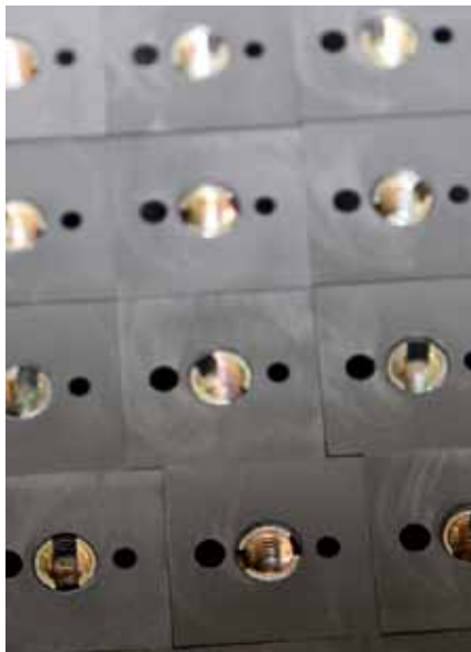
Graphitrohlinge mit eingebrachtem Bohrbild. Zwar sind die Schraubgewinde selbstschneidend, das Gewindeschneiden bringt indes Stabilität.
