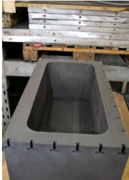
Große Werkstücke wie etwa dieser Tiegel für die Metallschmelze gehören ebenfalls zum Werkstückspektrum der Graphitspezialisten bei GTD.
