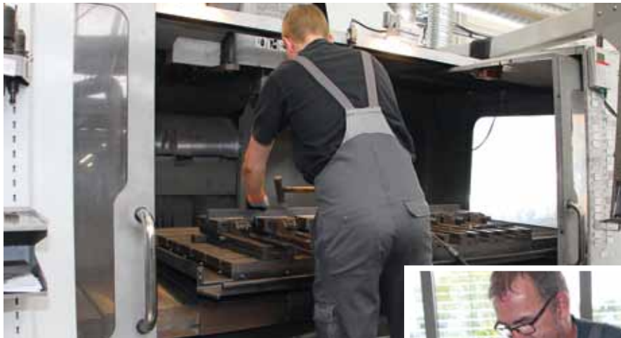
Auf der neuen VF-9 können auch größere Werkstücke bearbeitet werden – die Getriebespindel dreht bis 10 000 min -1 .
