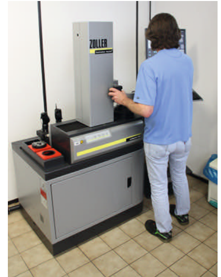
2 Gut vorbereitet: Exakt voreingestellte Werkzeuge sind Voraussetzung für genaues Bearbeiten
