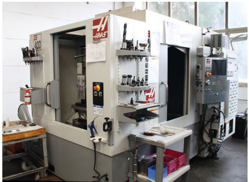
Bringt vermeintliche Gegensätze unter einen Hut: Das horizontale Bearbeitungszentrum EC 400 von Haas bietet gute Präzision in Verbindung mit niedrigen Kosten
